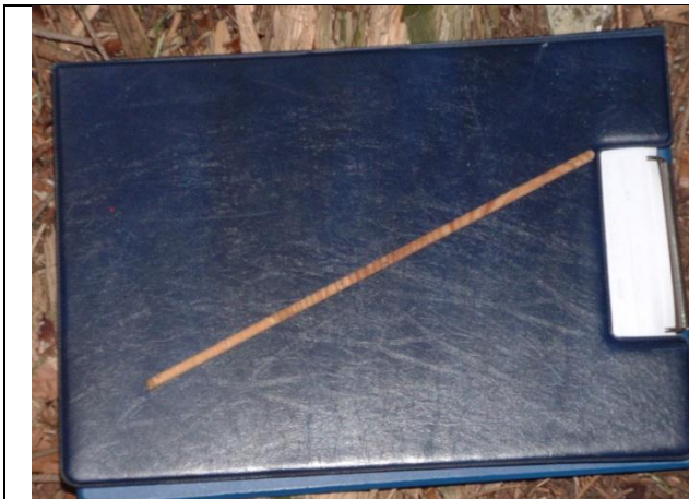
Campionamento dendrometrico – Prelievo di una carota per il conteggio degli anelli
